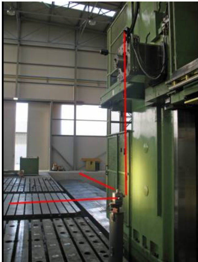
Macchina a montante mobile, si misurano rettilinearità verticale del montante, rettilinearità e perpendicolarità dell'asse RAM, parallelismo e planarità del piano 'Stolle' e planarità di movimento e posizionamento della tavola rotante.
