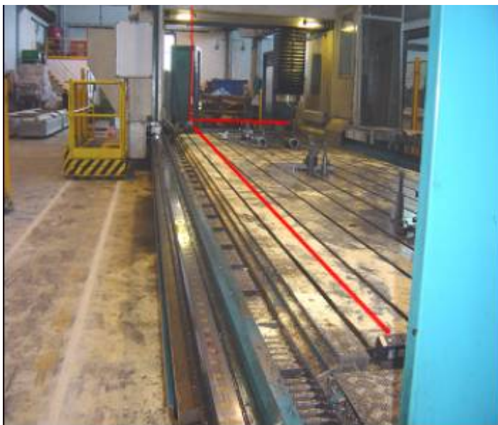
Rettilinearità planarità e perpendicolarità in una Macchina a portale di grosse dimensioni. Con un solo piazzamento si esplora tutta la macchina
