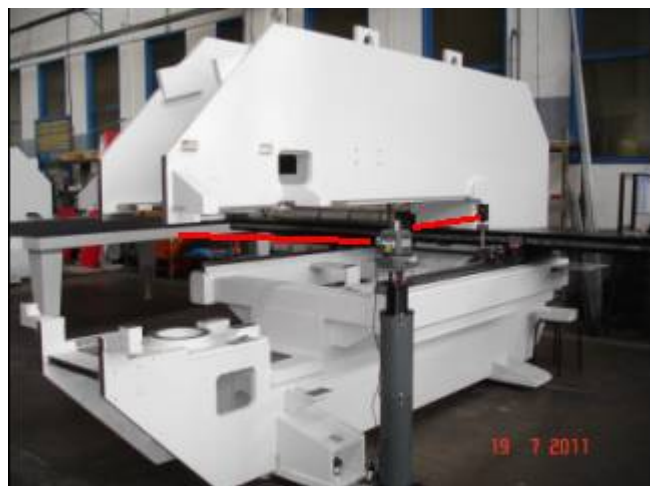
Macchina per la lavorazione della lamiera. Perpendicolarità degli assi di movimento.
