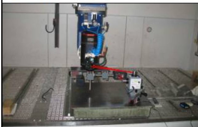
Fig.3- Fase-2a : Azzeramento dei sensori vicino al laser
