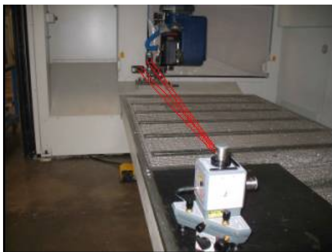
Fig-2 Fase-1b: Allineamento del laser parallelo al movimento X e misura rettilinearità Xy e Xz
